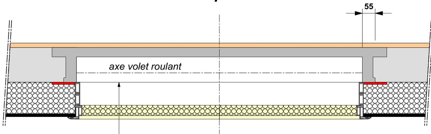
*Nota : étanchéité de liaison maçonnerie/menuiserie réalisée par un joint élastomère appliqué sur l'ensemble de la menuiserie*
