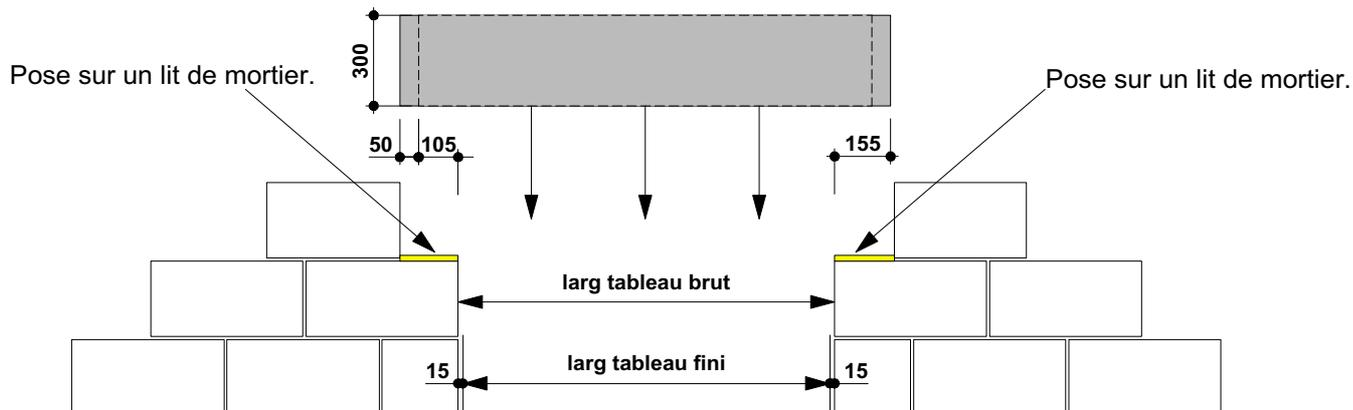
**ATTENTION HAUTEUR DE POSE : SE REFERER AU PLAN DU FABRICANT DE MENUISERIE**
