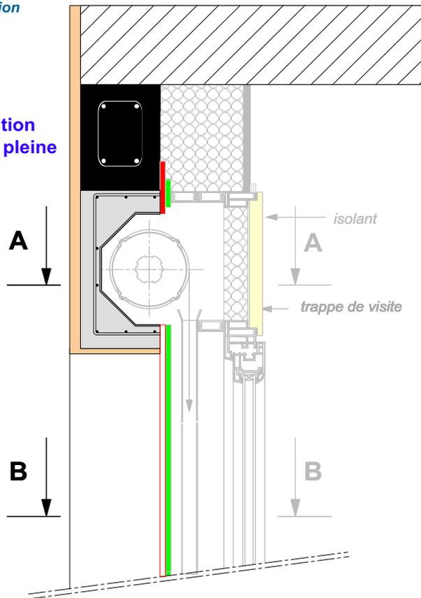
Un joint élastomère conforte l'étanchéité à l'air et à l'eau
