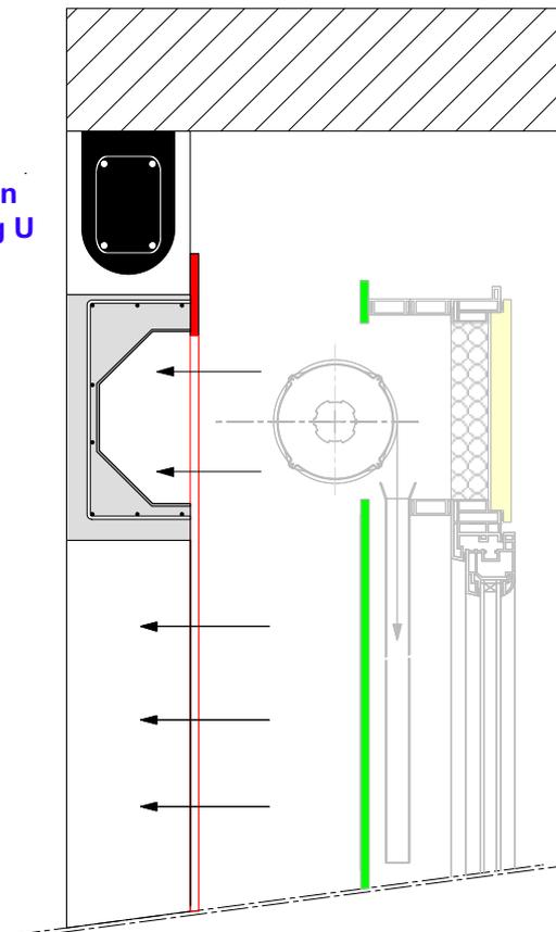
Un joint type compribande est collé sur l'ensemble de la menuiserie y compris sur la partie imposte permettant l'étanchéité à l'air et à l'eau
