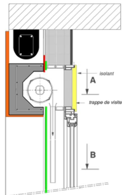
*Un joint élastomère conforte l'étanchéité à l'air et à l'eau*
