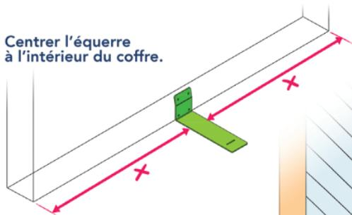
Fixer l'équerre renfort de sous face à l'aide de vis sur le profil aluminium comme indiqué.
