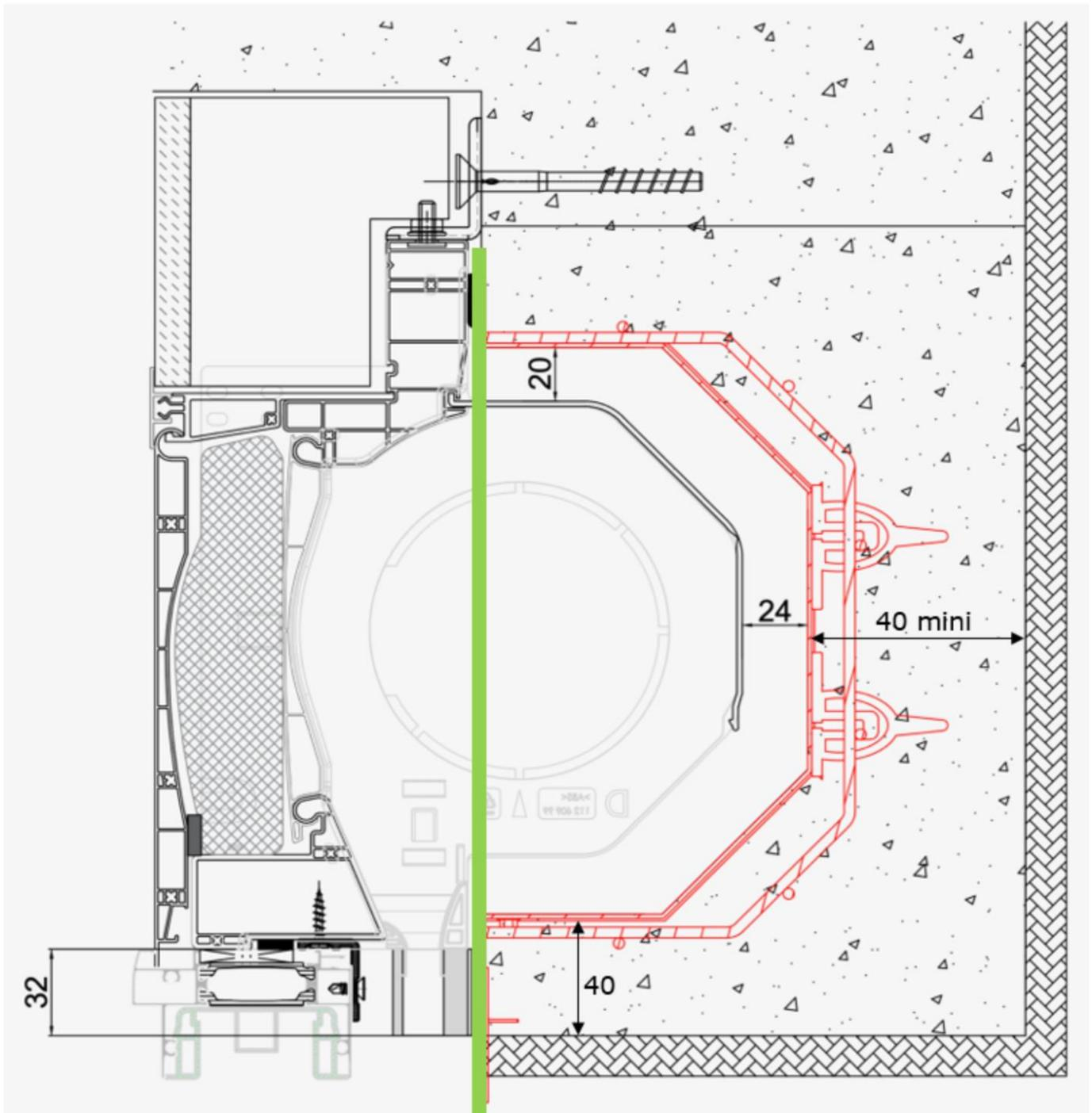
Figure 12 : Schéma de la trappe de visite par clipsage pour les réservations en C12
