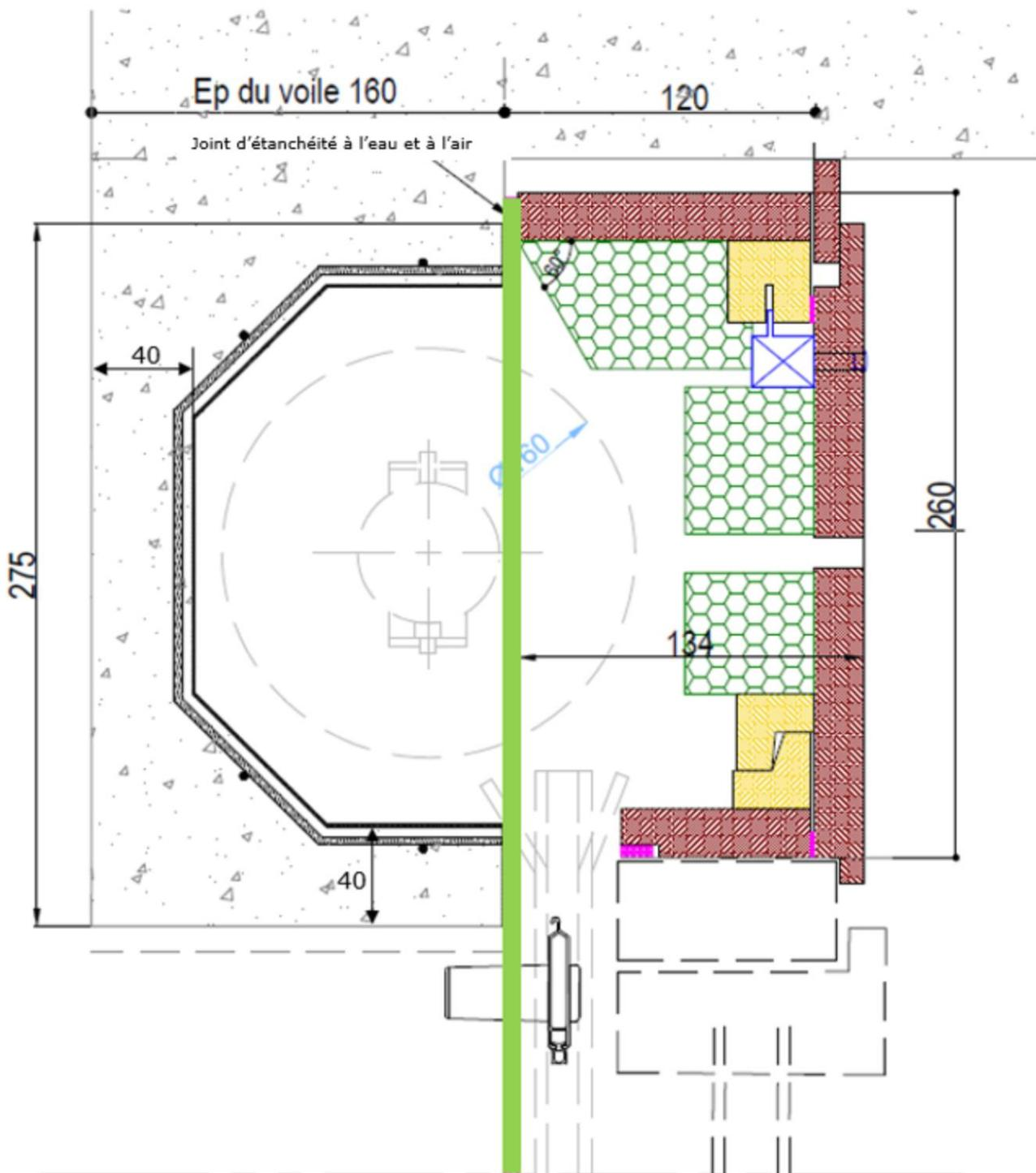
**Figure 11 : Schéma de la trappe de visite batteuse pour les réservations en C12**
